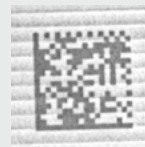
在切削痕上刻印的条码
